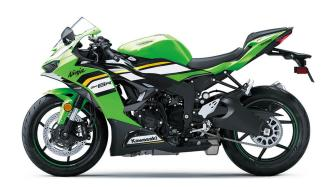
Discos dobles semiflotantes de 310 mm con pinzas dobles
